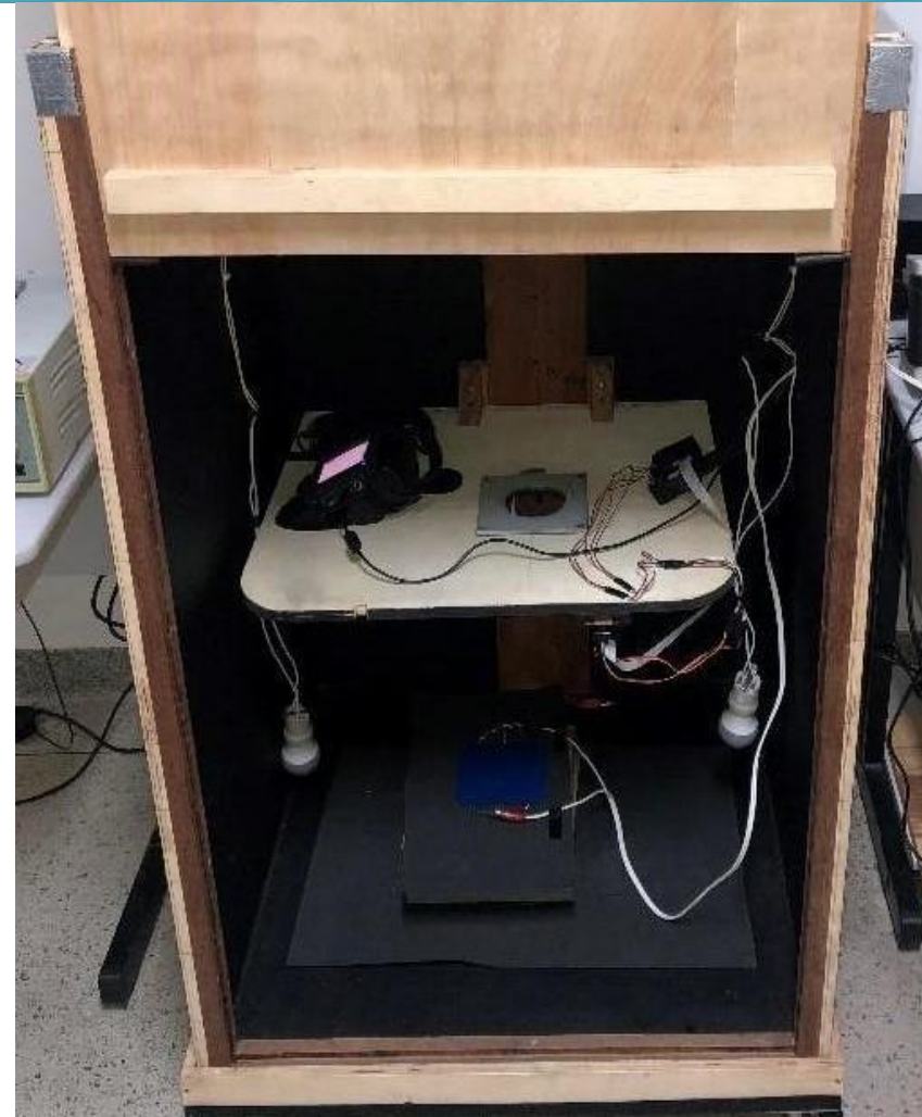
Figura 4 – Fotografia da parte interna da câmara escura usada no experimento mostrando a câmera IR e o posicionamento da célula fotovoltaica
