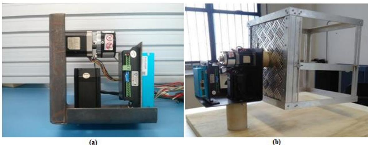
**Figura 2: (a) Segundo protótipo do seguidor solar e (b) suporte para lente Fresnel e células fotovoltaicas acoplado ao seguidor.**
